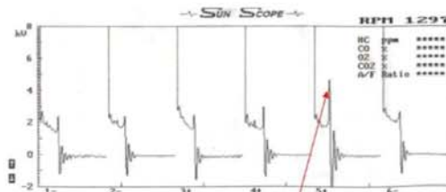
1997 Intrepid 3.5 con un DTC P0305. Fallo de encendido, mezcla pobre causado por una fuga de vacío en el canal de admisión # 5.
