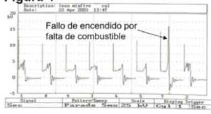
(Regresar) Ejemplos de fallos de encendido con DSO (prueba de aceleración rápida) Figura 4
